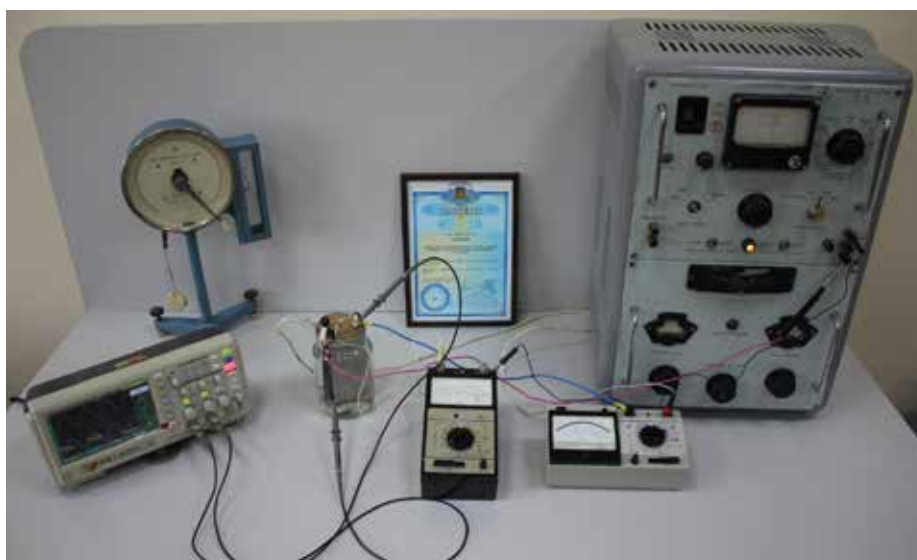
Фото. Інформаційно-вимірвальна система для визначення концентрації розчину електроліту за резонансною частотою коливань гідратованих іонів
