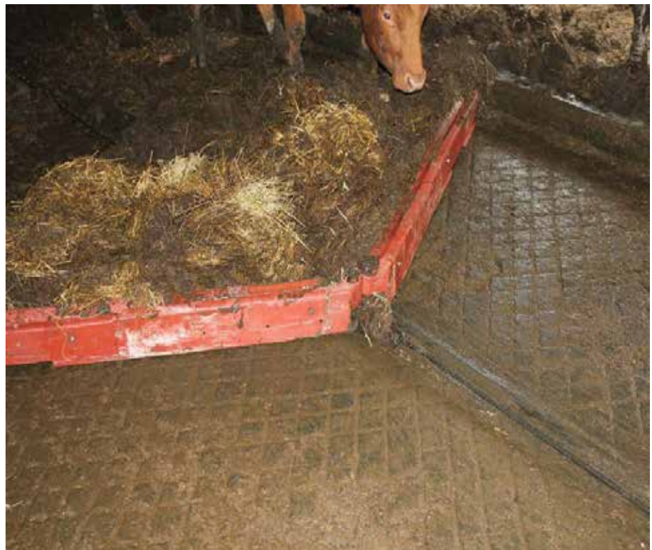
Фото. Скреперна установка в роботі
